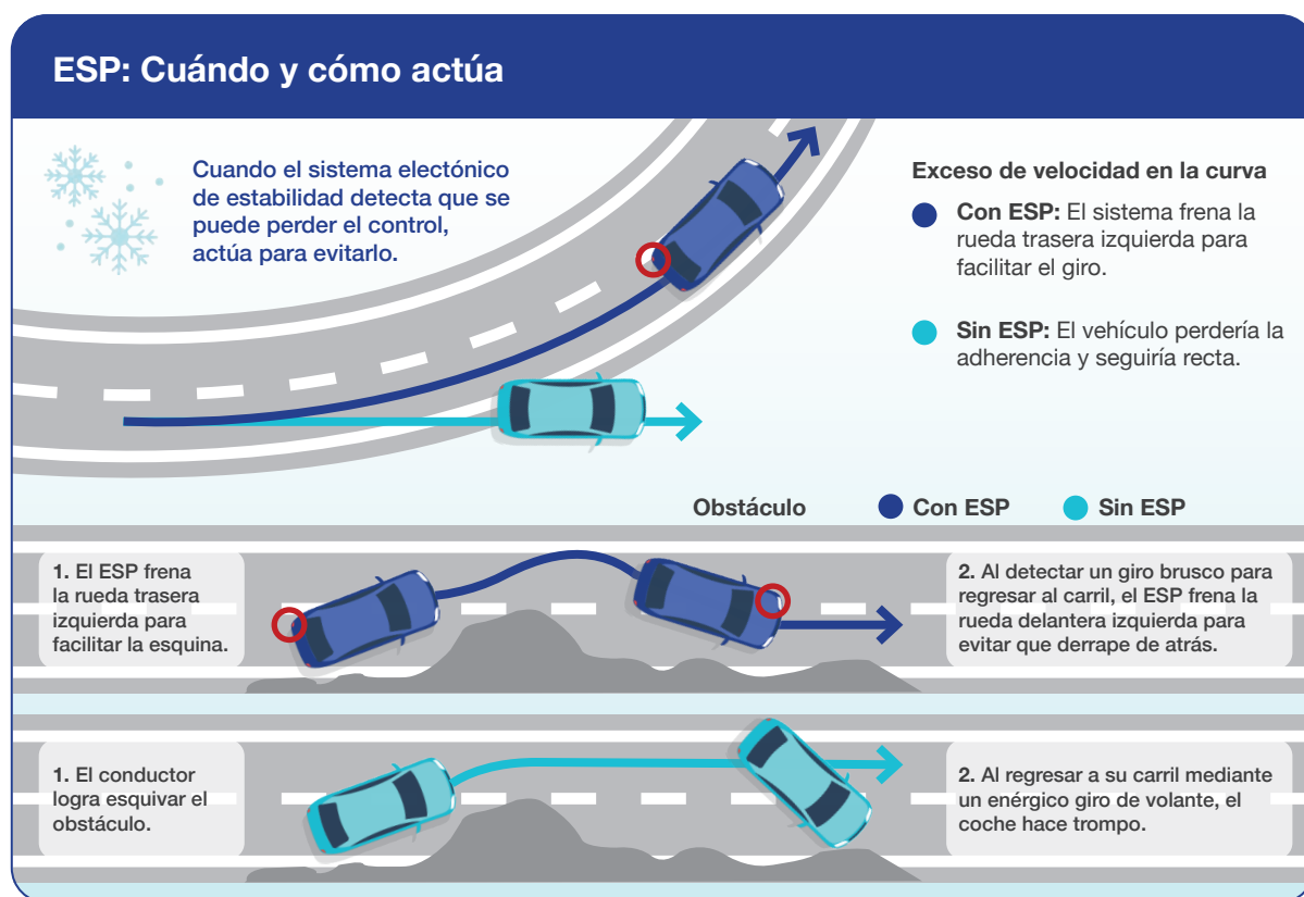
Figura 5: Funcionamiento de ESP - CONASET.
